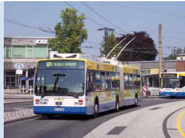
Die Oberleitungsbusse der Stadtwerke Solingen fahren rein elektrisch.
