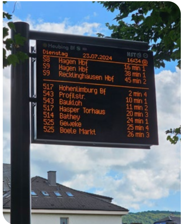
Abbildung 6-5: Beispiel DFI-Sammelanzeiger mit LED-Technik (Quelle: HVG-Hagen, Stand: 23.07.2024)
