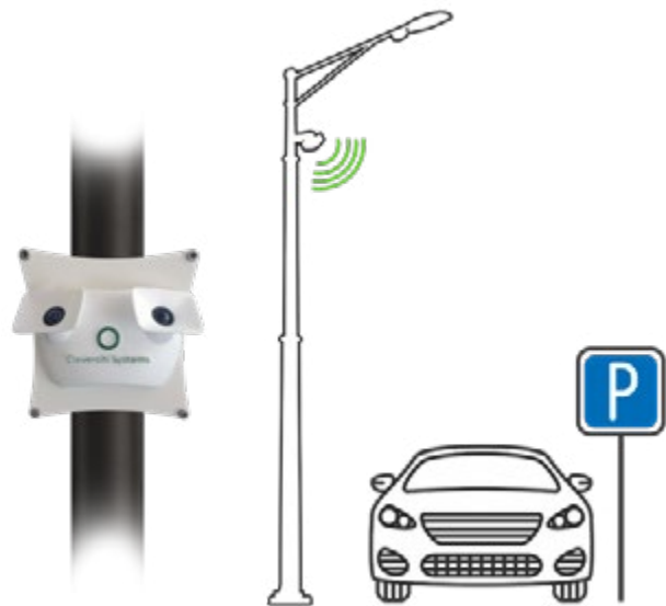
Abbildung 6-10: Optisches Erfassungssystem zur Belegerfassung für die P+R-Anlage Mettmann Stadtwald (Quelle: Cleverciti Systems GmbH)
