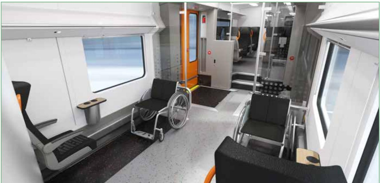
Foto 2-2: Blick in den Bereich der Rollstuhlstellplätze des RRX (Quelle: Siemens AG)
