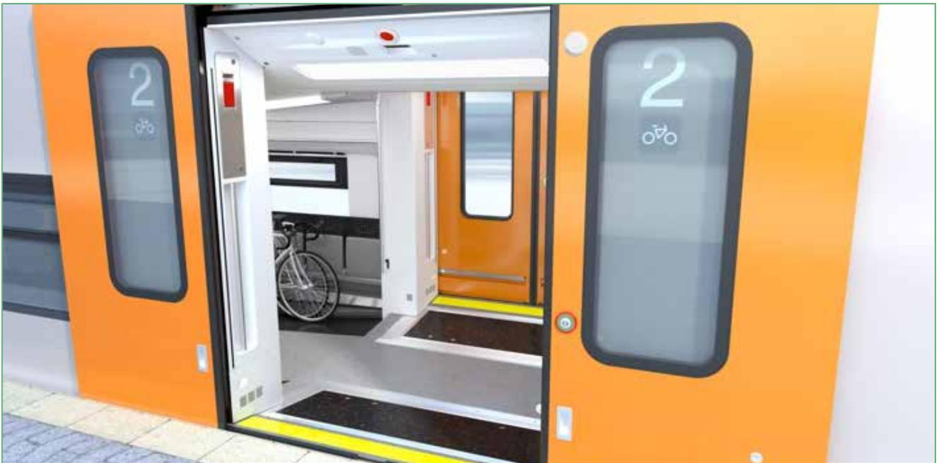
Foto 2-3: stufenloser Einstieg auch in die RRX-Doppelstockwagen (Quelle: Siemens AG)
