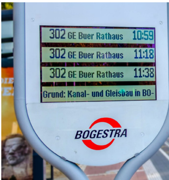
DFI-light-Anzeiger gewinnen ihre Energie und die Auskunftsdaten autark ohne Kabelanschluss und sind somit eine kostengünstige Alternative zu klassischen DFI-Anlagen.
