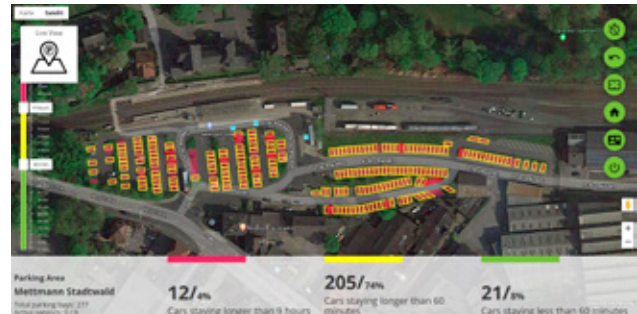
Belegungsdauer von einzelnen Stellplätzen auf der P+R-Anlage Mettmann Stadtwald (Quelle: Dashboard der Firma Cleverciti GmbH)
