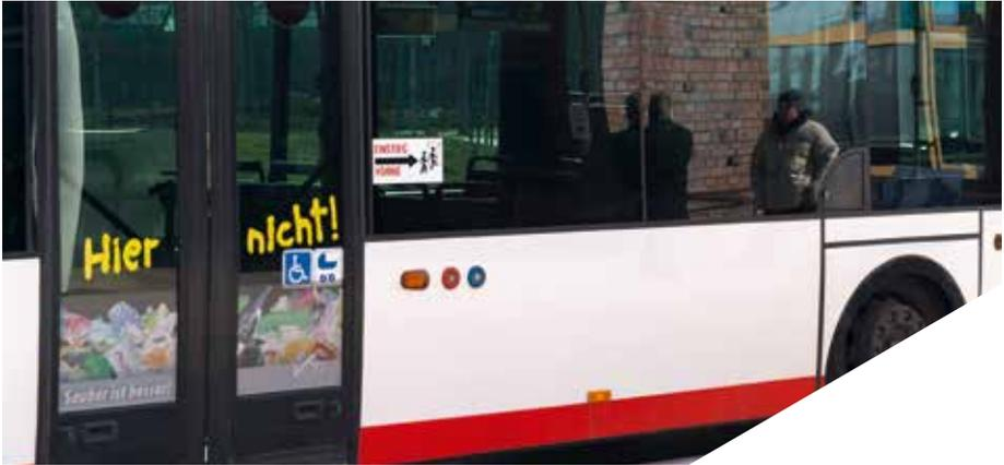
**Übrigens:** Sie müssen keine Angst davor haben, in den Türen eingeklemmt zu werden. Alle Türen sind nach modernsten Standards mit Sicherheitsmechanismen versehen. Sobald die Sensoren in der Tür einen Widerstand spüren, wird diese sofort automatisch wieder geöffnet. Sie können in Ruhe ein- und aussteigen.
